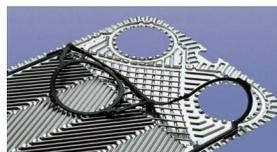
La construcción de la parte de entrada hace una perfecta distribución de los líquidos a través de la superficie de calentamiento. La parte de entrada es aumentado y provisto de ranuras que evitan los "puntos muertos" que puede causar el crecimiento de bacterias en el calor de la placa intercambiador. La entrada asegura una parte de entrada fuerte con un mínimo de puntos de contacto.
